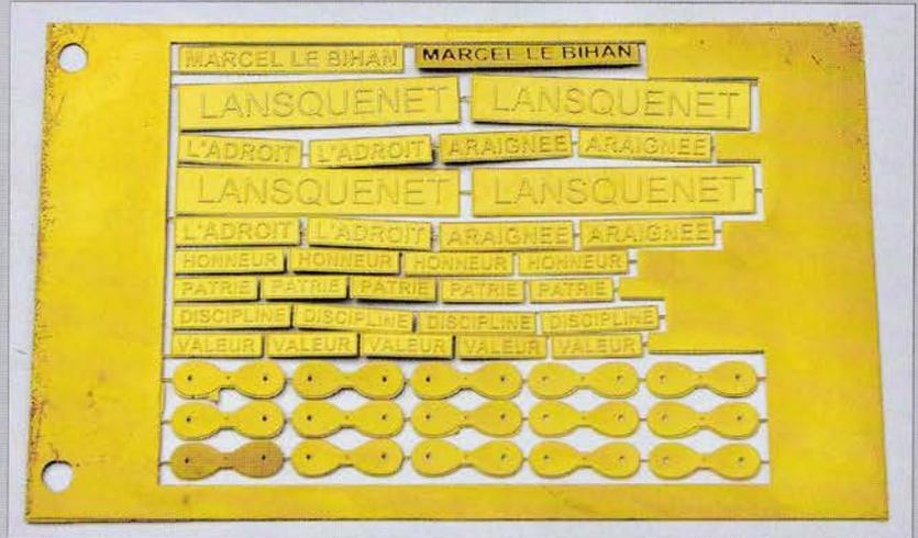
insérer deux crochets non métalliques pour la suspendre dans la cuve de traitement.
